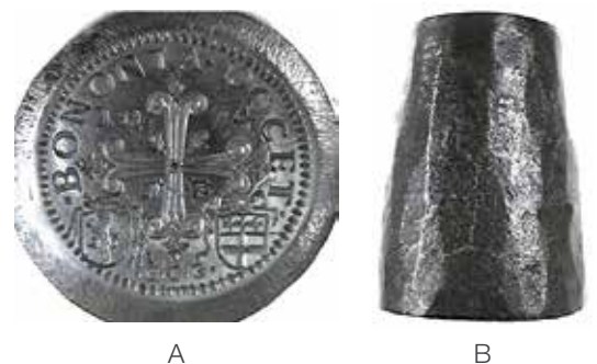
Fig. 10. Conio per il rovescio di una quadrupla con data 1674 conservato presso il Museo Civico di Bologna (inv. 86232) eseguito da Pietro Todeschi. A. Riproduzione speculare dell'impronta del conio (l'impronta è stata riprodotta in modo speculare per poterla confrontare meglio con le monete). B. Visione laterale del conio.
